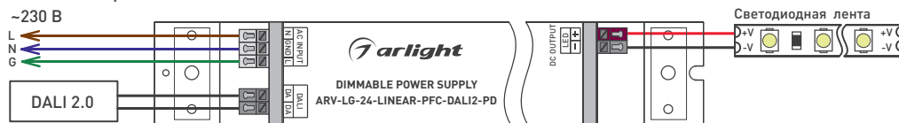
Рис. 1. Подключение источника питания при использовании интерфейса DALI 2.0
