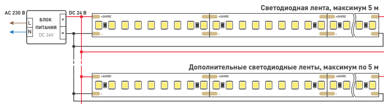
Схема 2. Подключение нескольких светодиодных лент с двух сторон для обеспечения равномерного свечения ленты по всей длине
