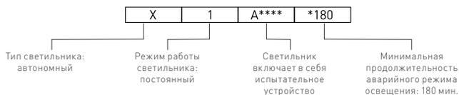
Автономный аварийный светильник постоянного действия, включающий испытательное устройство с продолжительностью работы в аварийном режиме освещения 180 мин.
