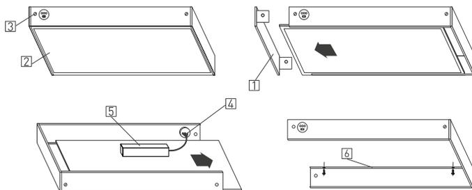
Рис. 2. Установка и подключение светильника
